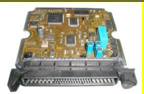
CENTRALINA DI GESTIONE MOTORE EDC15C2 INSTALLATA SULLE VETTURE DEL GRUPPO PSA\FIAT HDI EURO2
